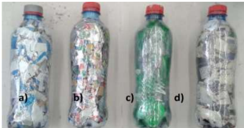
Figura 1. Muestras de ladrillos ecológicos con rellenos de un solo tipo: (a) Tetrapak; (b) metales; (c): PET; (d) papel y cartón
