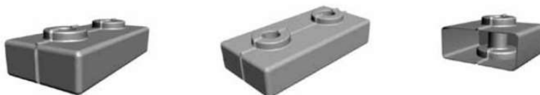
Figura 3. Modelo de tabique de plástico reciclado
